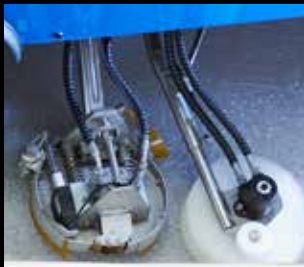
Bandenfräser aus rostfreiem Edelstahl, gefedert und elektronisch höhenverstellbar
