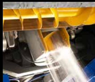
Impianto lavaggio coclea verticale
