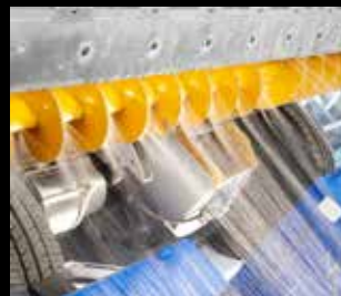
Impianto lavaggio coclea orizzontale
