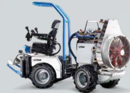
Sprüher SP 200-60Q Axial-Querstromgebläse 36
