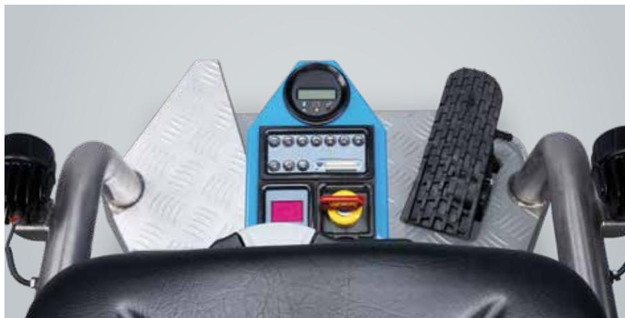
La velocità può essere regolata gradualmente, mediante il pedale ergonomico, sino a 10 km/h. Il predellino per il piede sinistro è inclinato, consentendo così un assetto stabile anche su terreni ripidi.
