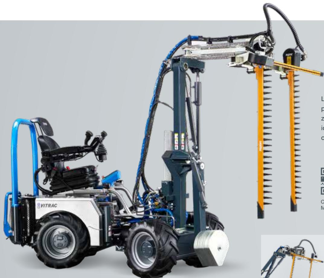
La cimatrice LSU è stata sviluppata appositamente per l'impiego in spazi ridotti e terreni ripidi. La zavorra, collocata in basso e dotata di oscillazione idraulica, garantisce un'elevata stabilità in tutte le condizioni di lavoro.
