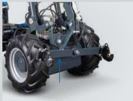
Il telaio aggiuntivo a controllo idraulico consente l'orientamento laterale degli accessori di  $\pm 8^\circ$  (optional).
