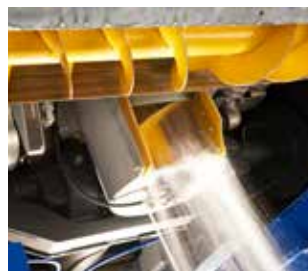
Schnecken- waschanlage vertikal kann während der Eisbearbeitung aktiviert werden
