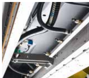
Eiswaschanlage Multijet mit Absaugleiste
