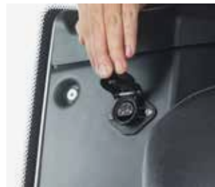
12V-Steckdose schaltbar nach DIN 9680
