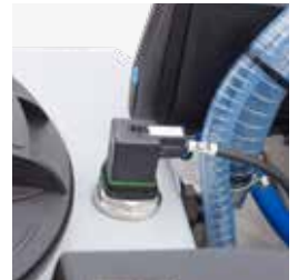
Füllstandsensor im Tank
