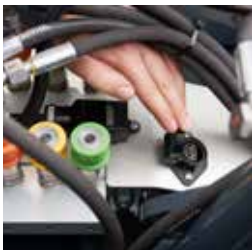
12V-Steckdose schaltbar nach DIN 9680
