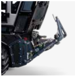
Front-Hubwerk mit Kupplungsdreieck Kat. 0
