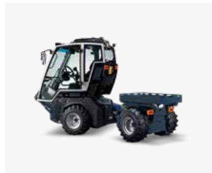
Pianale di carico
