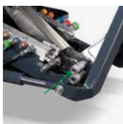
Collegamenti alla seconda pompa ad ingranaggi
