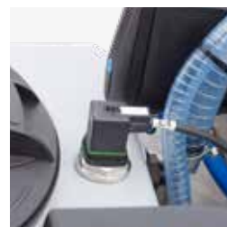
Sensore di livello liquido all'interno del serbatoio
