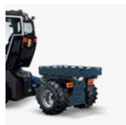
Pianale di carico
