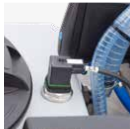
Sensore di livello liquido all'interno del serbatoio
