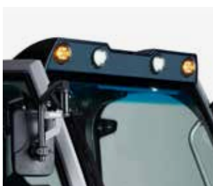
Illuminazione per la circolazione stradale
