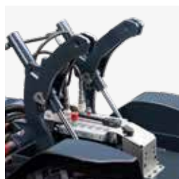
Sollevatore con distributore idraulico
