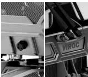
Passacavo a 14 PIN con spina anteriore e posteriore
