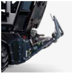
Front-Hubwerk mit Kupplungsdreieck Kat. 0
